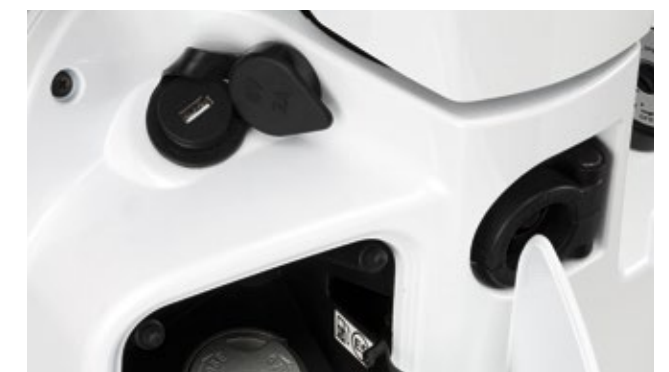
Toma de carga USB QC2.0 y gancho porta bultos escamoteable
